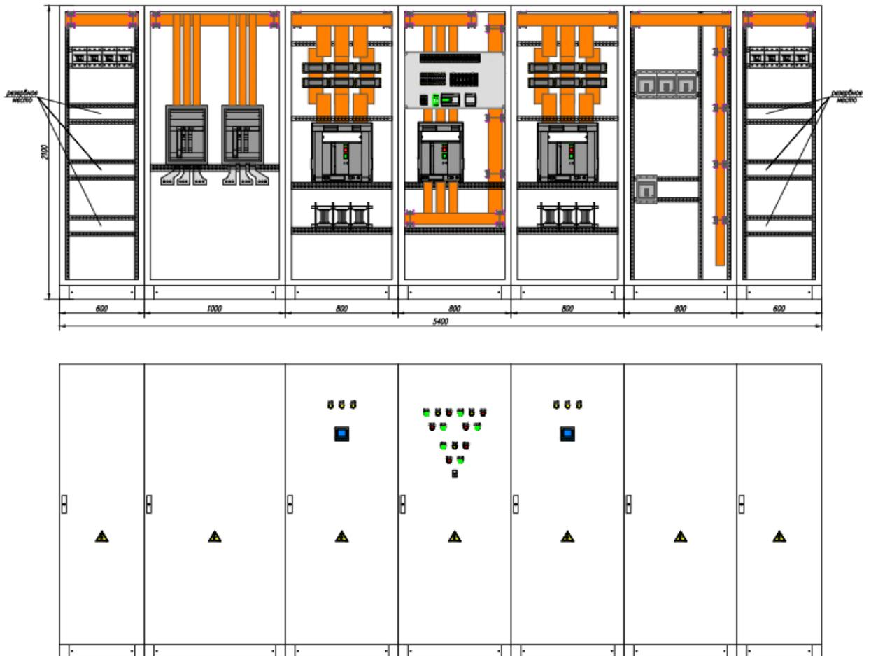
Рисунок 8. Компоновка ГРЩ
